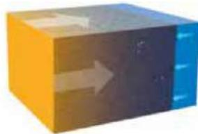
2. PENETRON se aplica en el lado positivo o negativo. Los productos químicos PENETRON penetran profundamente en el hormigón.
