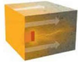
4. Se aplican dos capas de PENETRON. La tecnología cristalina bloquea permanentemente la penetración de la humedad.
